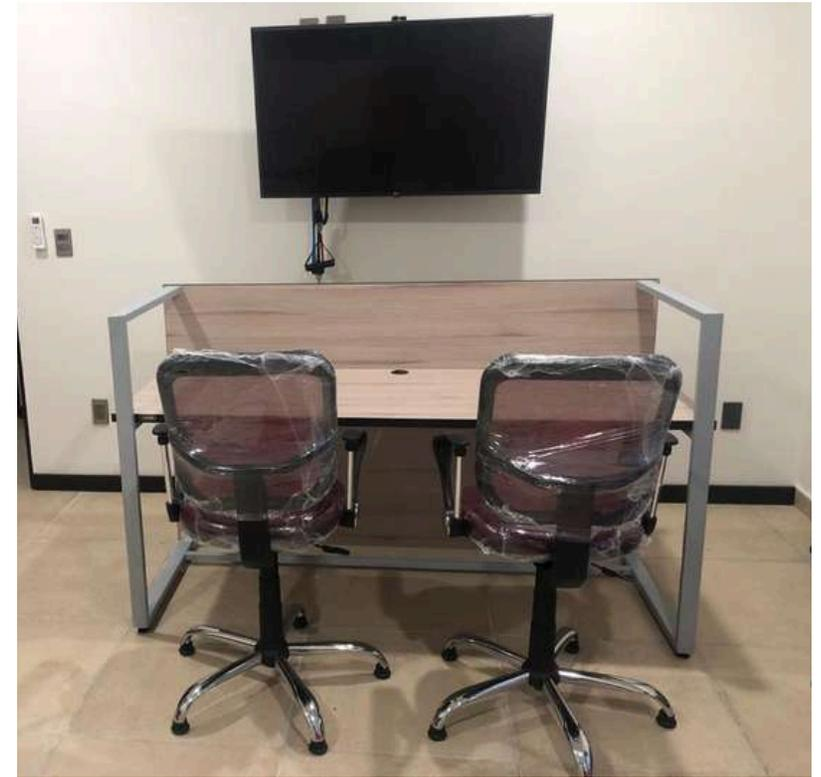
FABRICADO CON ESTRUCTURA METALICA, COMPUESTA POR 2 SOPORTES CUADRADOS DE TUBULAR RECTANGULAR DE 2" X 1" CAL 18 CON NIVELADORES METALICOS PARA AJUSTE DE ALTURA, INCLUYE 2 LARGUEROS DE TUBO CUADRADO REFORZADO DE 1" CAL 18, CON OREJAS PARA FIJACION DE CUBIERTA DE LAMINA CAL 14. TODO CON ACABADO EN PINTURA AL HORNO.
